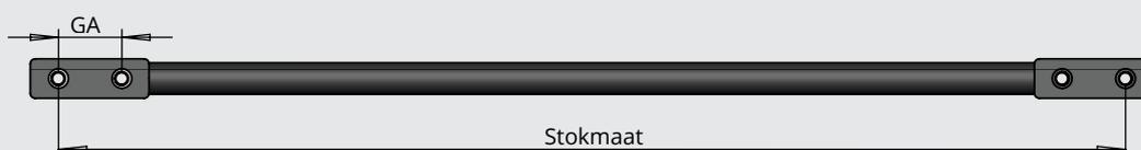
Para determinar el ancho correcto de la cinta transportadora, es importante que las varillas tengan el "stokmaat" correcto. Esta es la distancia entre los dos orificios exteriores de las varillas, C.T.C. Cuando solicite las varillas cueltas es importante que mencione el stokmaat, además de la distancias entre los orificios de un extremo.
